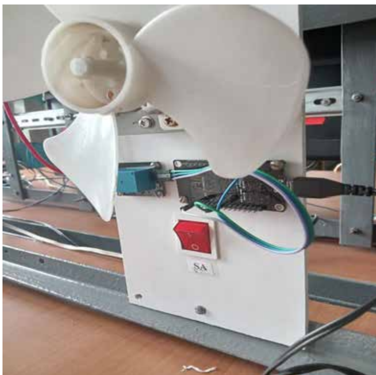
Рис. 1. Зовнішній вид пристрою дистанційного програмованого керування електровентиллятором
