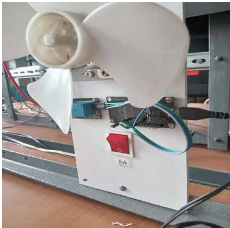
Рис. 1. Зовнішній вид пристрою дистанційного програмованого керування електровентиллятором
