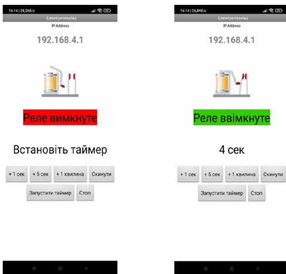
Рис. 2. Інтерфейс програмного забезпечення з візуалізацією стану реле
