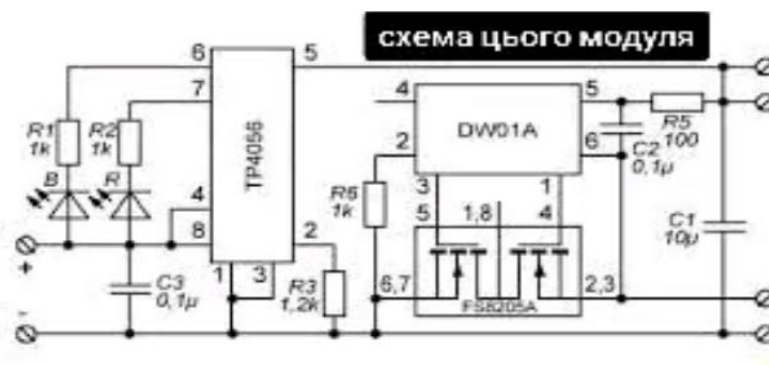
Рис. 2. Принципова схема контролера TP4056
