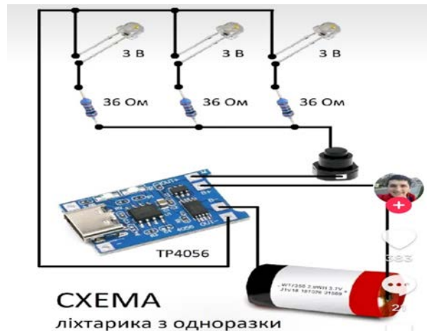
Рис. 1. Монтажна схема ліхтарика (адаптовано з [8])
