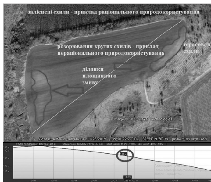
Рис. 2. Дослідження взаємозв'язків між розораністю схилів значної крутизни та деградацією ґрунтового покриття за допомогою технологій супутникового моніторингу в ресурсі «Google Планета Земля» (супутниковий знімок околиць с. Семигірья Кіровоградської області)
